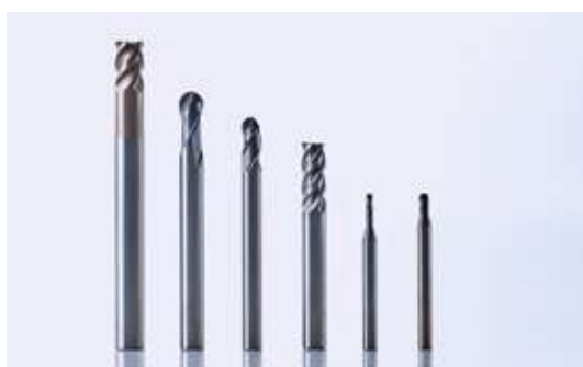
【写真2】超硬エンドミル。穴をあけるPCBドリルに対して、側面にも刃があるエンドミルは3次元形状を削ることができる。特に外形6mm以下の小径サイズでは、その品質と豊富なラインナップに定評がある。金型産業をはじめ、自動車産業、携帯端末機器、航空機部品など幅広い分野で使用されている。
