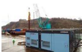
大河津分水路拡幅工事において、同社のエンジンコンプレッサ(可搬性に優れ、一般的の土木工事、建設、道路工事など電源設備のない現場や移動する現場のエアー源として使用される)が活躍しています。
