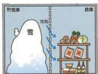
生可能エネルギーのひとつとして、全国に先がけて活用してきました。農作物の貯蔵や建物の冷房を用途とする雪室を市内各地に設置。
